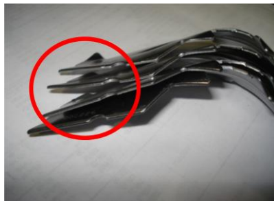
Figura 2.4 Defecto de golpe en los álabes.
