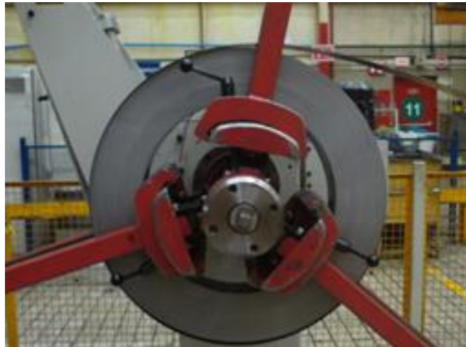
Figura 4.7 Materia prima montada en el alimentador de la prensa.
