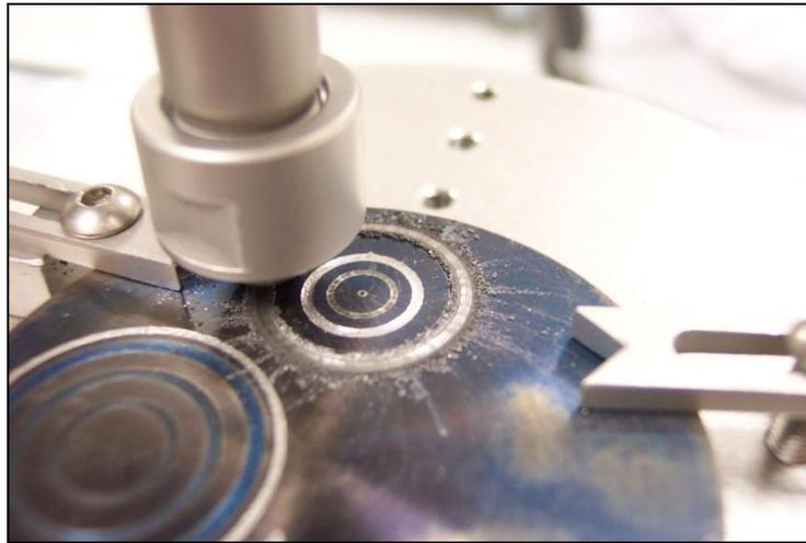
**Figura 3.11.** Esquema representativo del desgaste realizado con la prueba de pin-on-disk.
