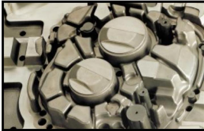
**Figura 3. 4.** Acero grado herramienta para trabajo en caliente [17].
