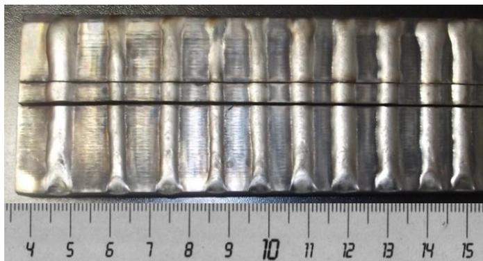
**Figura 5. 10.** Cordones de soldadura realizados con aporte base Fe en el substrato de acero D2.
