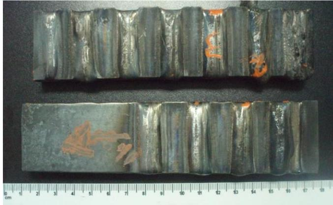
**Figura 5. 39.** Recubrimientos realizados para evaluar con las pruebas de desgaste.
