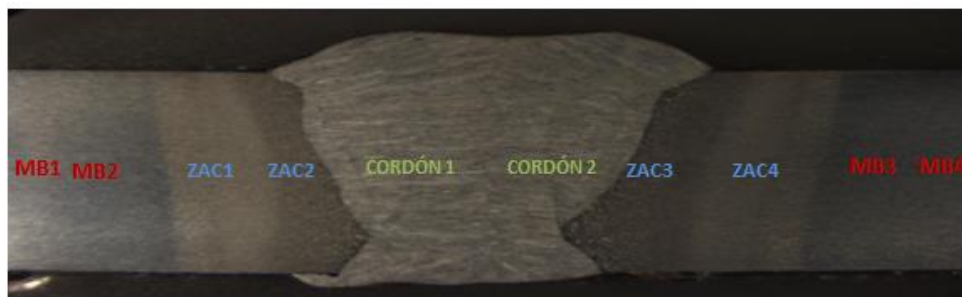
Figura 47. Identificación de zonas para el análisis de microdureza
