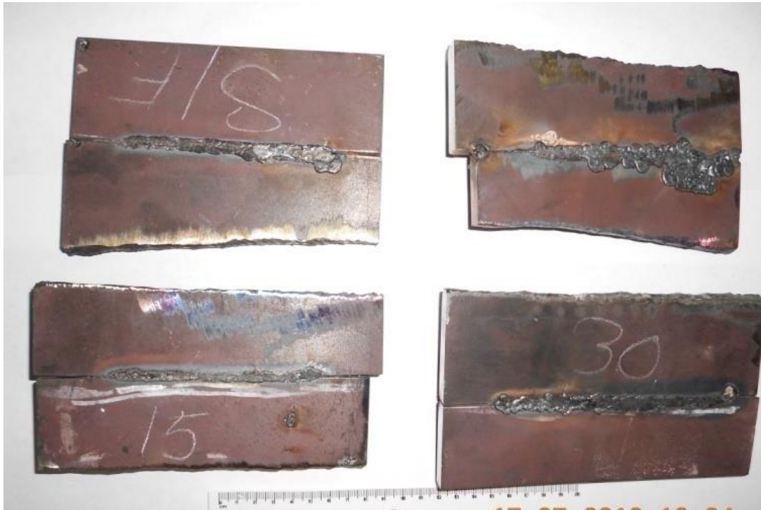
Figura 35. Acero API 5L X65 soldado con diferentes cantidades de nanopartículas de TiN
