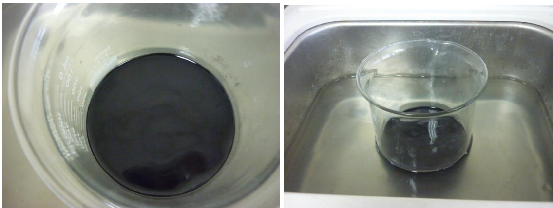
Figura 29. Impregnación y dispersión de nanopartículas de TiN en fundente industrial 995N
