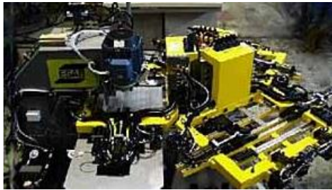
Figura 2.212422-22 Producción de FSW en asientos traseros del carro Volvo. (20)
