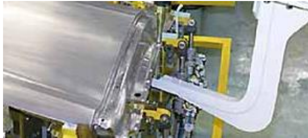
Figura 2.2222232-23. FSSW para las puertas traseras del Mazda RX-8. (20)
