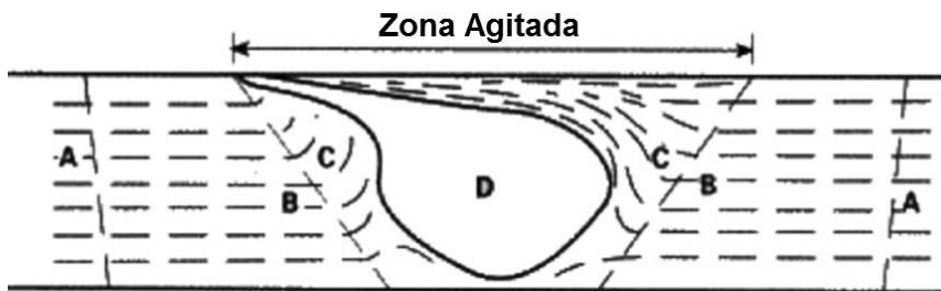
Figura 2.3342-4 Esquema de la sección transversal de una soldadura efectuada por FSW en la que se muestra 4 zonas distintas: (A) Metal Base, (B) Zona Afectada por el Calor, (C) Zona Afectada-Termo-Mecánicamente Afectada y (D) Zona Agitada o Botón de Soldadura. (1)
