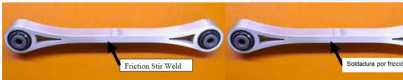
Figura 2.1414152-15 Brazo automotriz fabricado de extrusiones soldadas por FSW. (19)
