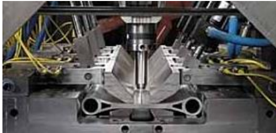
Figura 2.202021-2.24 Suspensión trasera soldada por FSW para las limosinas Lincoln. (20)
