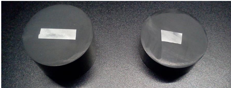
Figura 4.24.2 Muestras transversal y longitudinal del material base montadas en baquelita.
