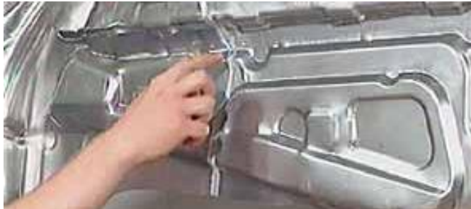
Figura 2.1747482-48 Tailored blank soldado por FSW producido de la serie de aluminio 6000 en 1998. TWI, BMW, Land Rover. (20)
