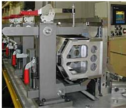
Figura 2.19-19-2-20 Soldadura por FSW aplicada en la consola central del Ford GT. (20)
