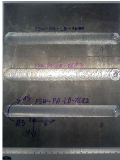
Figura 4.3.4.3 Uniones de soldadura en placas del material AMC elaborados con distintos parámetros de soldadura FSW.
