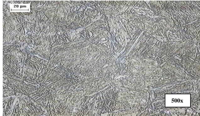
**Figura 34** Zona afectada por el calor adyacente a la zona de fusión TRIP 780 a 500x.
