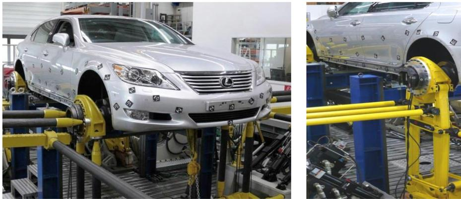
Figura 3 Sistema de actuadores para pruebas a esfuerzos cíclicos reales.
