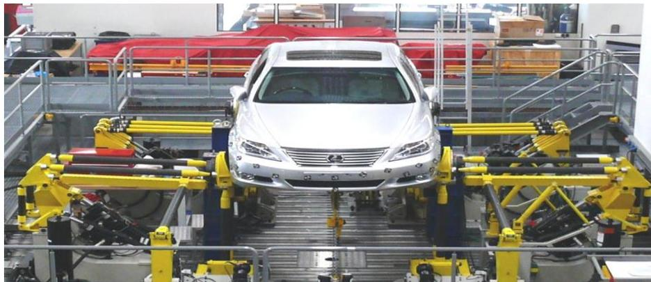
Figura 4 Automóvil completo sometido a esfuerzos cíclicos.
