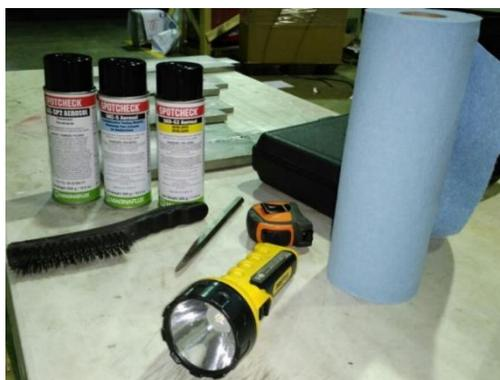
**Figura 4. 11 Material para procedimiento de inspección por líquidos penetrantes.**
