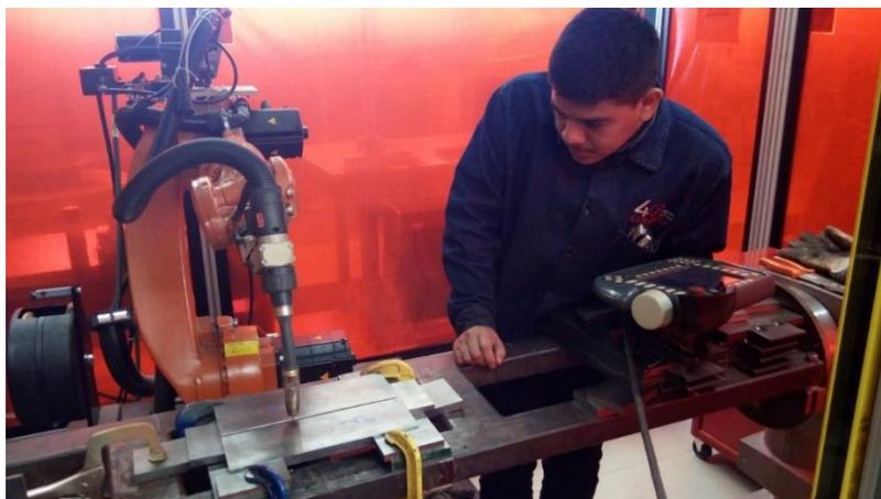
**Figura 4. 4** Celda de soldadura GMAW robotizada, con brazo robótico KUKA KR16.
