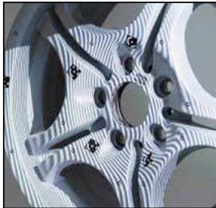
Figura 3. 5 Ilustración de escaneo mediante luz estructurada sobre superficie de geometría compleja (14).
