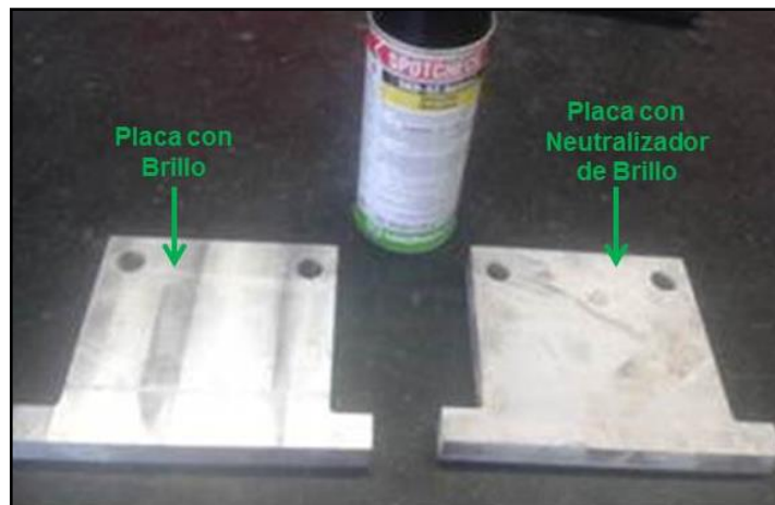
Figura 5.1 Ilustración donde se ejemplifica cómo se neutraliza el brillo superficial con polvo revelador para llevar a cabo un escaneo con equipo láser portátil.
