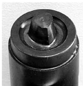
Figura 4.6 Herramienta Trivex desarrollada en TWI
