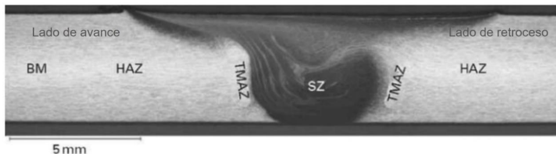
Figura 2.8. Zonas de la unión FSW
