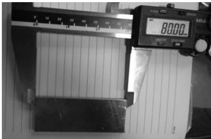
Figura 4.2 Placas de material compuesto A359/SiC/20p
