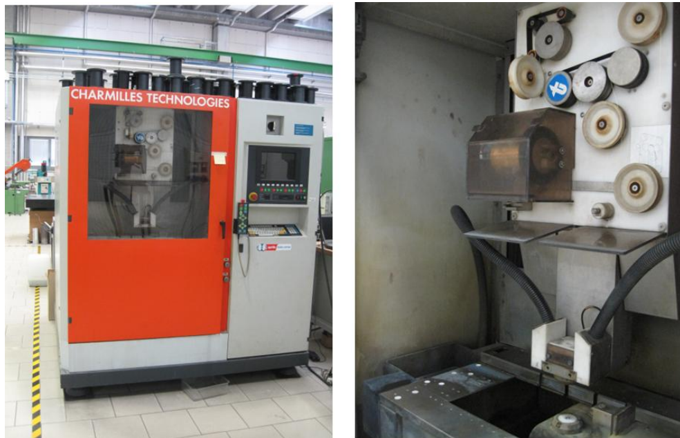
Figura 4. 2 Equipo de electroerosión por hilo marca Charmilles Technologies Gevene modelo 290
