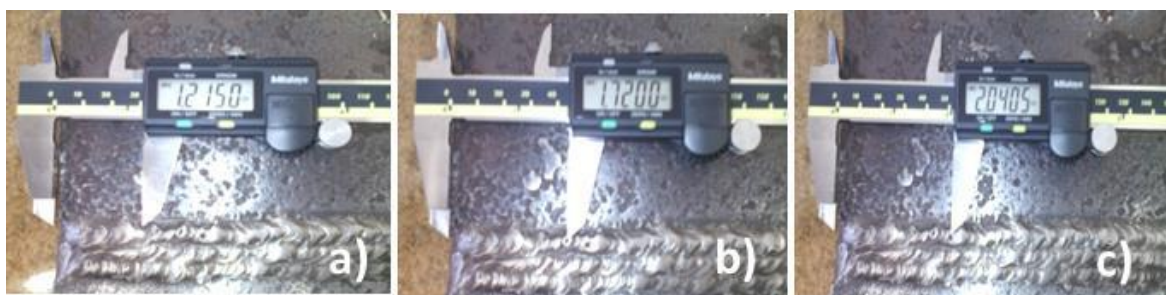
Fig. 3.43 Medición de distancia de defectos: a) Socavado, b) Poro y c) Poro.
