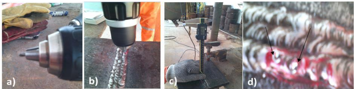
Fig. 3.47 Realización de: a) Ajuste de broca, b) Perforación de extremo c) Distancia perforada, d) Vista del barrenado.
