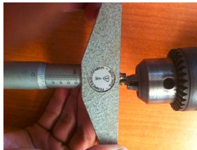
Fig. 2.16 Sujeción de broca para Profundidad adecuada.
