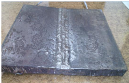
Fig.3.42 Placa soldada de probeta.
