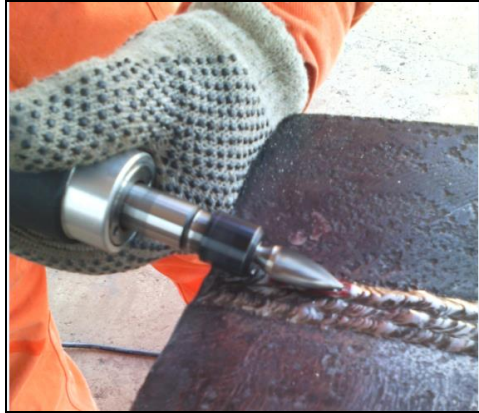
Fig. 3.48. Desbaste superficial de la indicación
