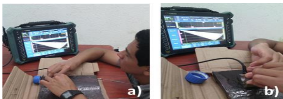
Fig. 3.56 a) verificación de la reparación por arreglo de fases, b) No presento indicaciones.
