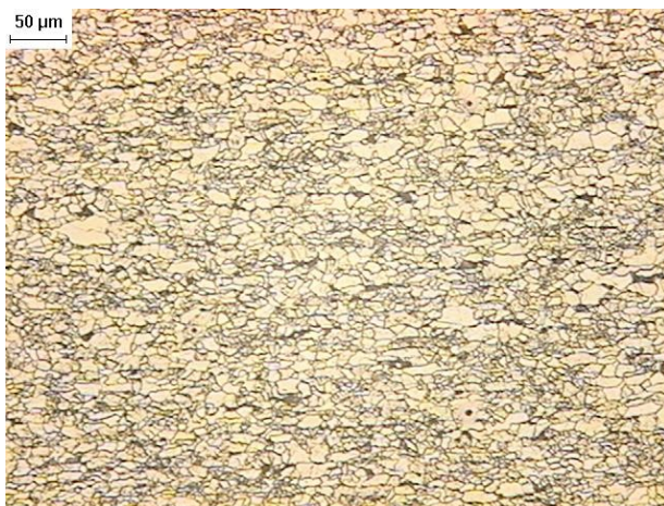
Figura 3.31. Microestructura de Ferrita zonas blancas y Perlita zonas oscuras, 100X (nital 5%) [41] .
