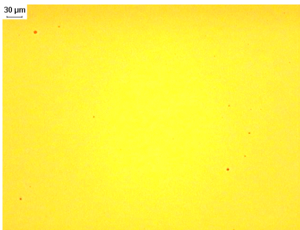
Figura 3.30. Distribución de inclusiones no metálicas en material puntos negros, 100X. (Sin ataque) [41] .
