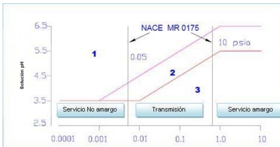
Figura 3.22. Regiones de severidad para SSC para aceros al carbono. [27]
