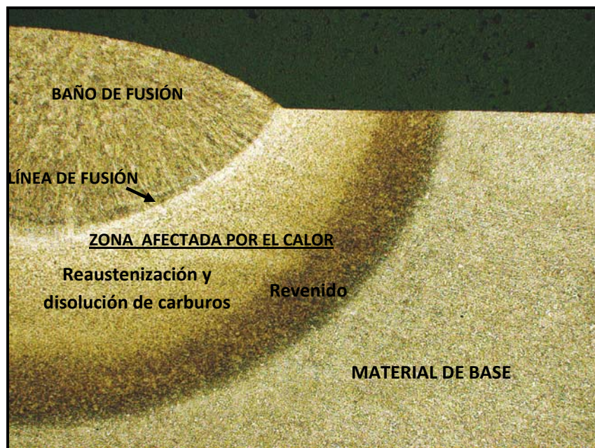
Figura 2.2. Esquema de las regiones de una soldadura. [2]
