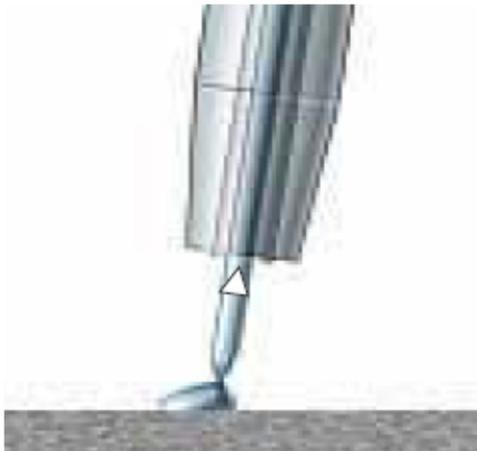
**Existe un movimiento de retorno del hilo, soporta el desprendimiento de la gota durante el corto circuito**
