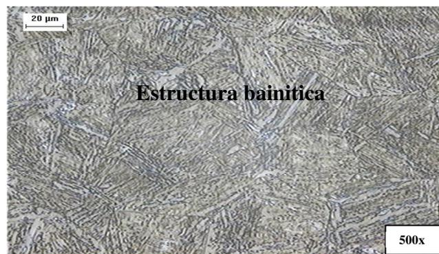
**Figura 4.27** Zona afectada por el calor adyacente a la zona de fusión TRIP 780 a 500x.
