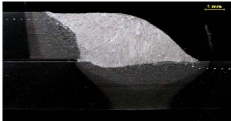
**Figura 2.33** Macro ataque de acero DP 600 usando corriente alterna <sup>[9]</sup>
