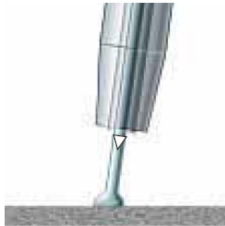
**El arco se apaga cuando el material se sumerge en el baño de fusión.**
