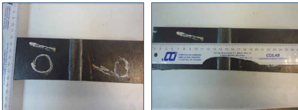
Figura 4.2. Preparación de placa de acero API 5L X70 por (SAW) para medición de esfuerzos residuales.
