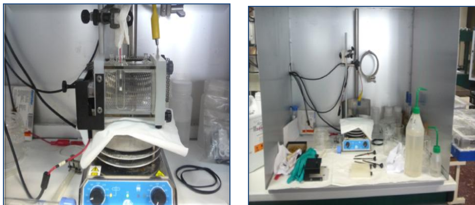
Figura 4.4. Montaje de celda electrolítica.
