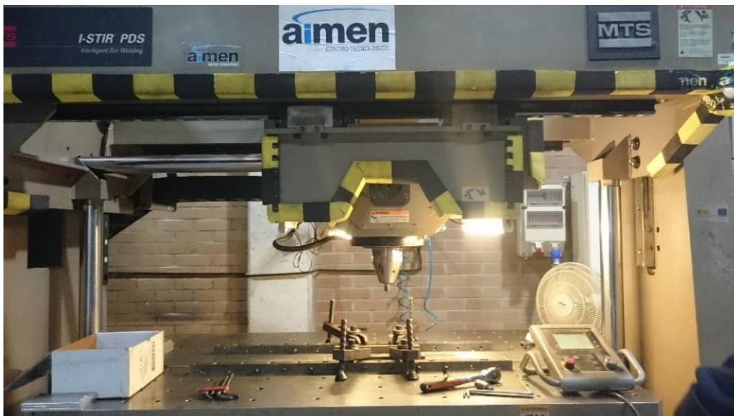
Figura 4.3 Equipo STIR PDS Intelligent Stir Welding MTS
