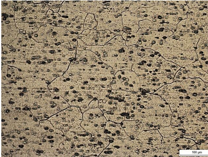
Figura 4.5 Micrografía de la aleación A6061-T6
