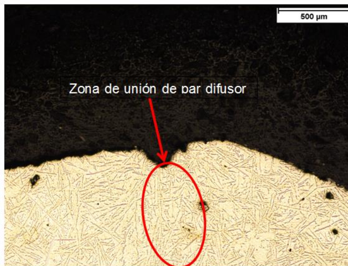
Figura 40.- Micrografía de la unión del par difusor Al-Al a 650°C por 30 min de permanencia en el equipo de Análisis Térmico Diferencial
