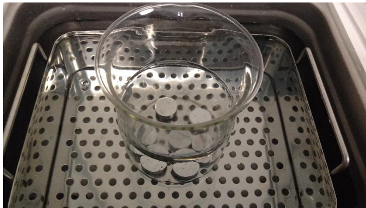
Figura 15. Limpieza ultrasónica de las muestras
