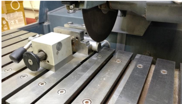
Figura 12. Barra de metal posicionada para el corte
