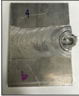
Figura 6.12 Ausencia de rebaba y presencia de hueco, muestra 5
