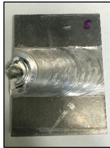
Figura 6.13 Ausencia de rebaba y presencia de hueco, muestra 6
