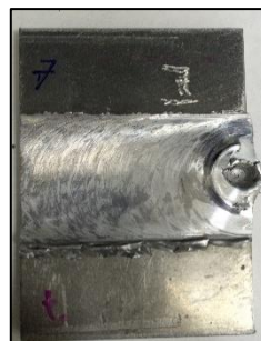
Figura 6.15 Presencia de rebaba y ausencia de hueco, muestra 8
