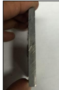
Figura 6.13 Ausencia de rebaba y presencia de hueco, muestra 6
