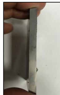
Figura 6.15 Presencia de rebaba y ausencia de hueco, muestra 8
