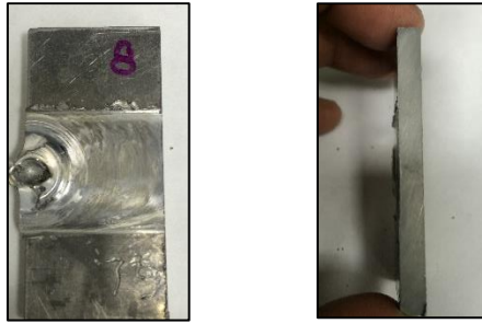
Figura 6.16 Ausencia de rebaba y hueco, muestra 9
