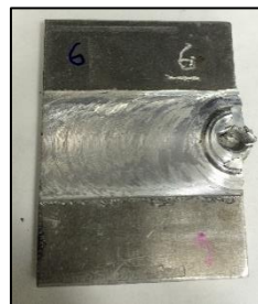
Figura 6.14 Ausencia de rebaba y hueco, muestra 7
