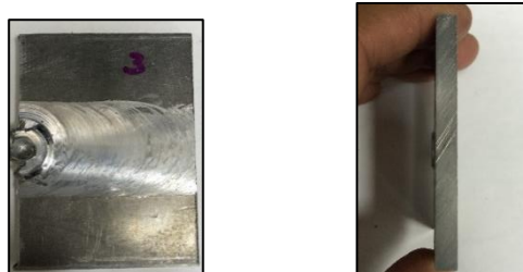
Figura 6.11 Ausencia de rebaba y hueco, muestra 4
