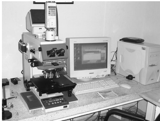
Figura 17.- Analizador de imágenes Olympus Vanox AHMT3 utilizado en la investigación.
