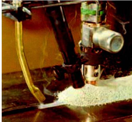
Fig. 2. 7 Proceso de soldadura SAW para componentes marítimos **(20)**
