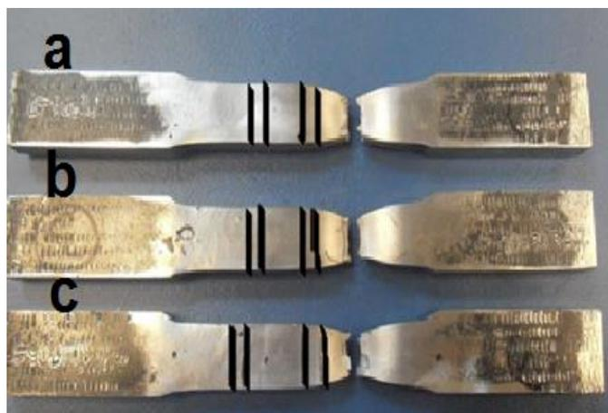
Fig. 5. 33 Probetas tensionadas donde se puede observar que la fractura se encuentra en el metal base
