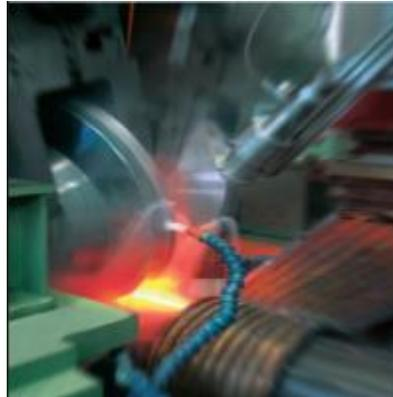
Fig. 2. 10 Proceso de soldadura por resistencia en costura para tuberías **(31)**
