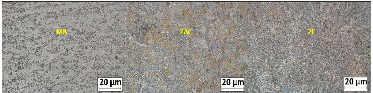
Fig. 5. 19 Micrografía unión HLAW a 500x, donde MB – Metal base, ZAC – Zona afectada por el calor y ZF – Zona de fusión
