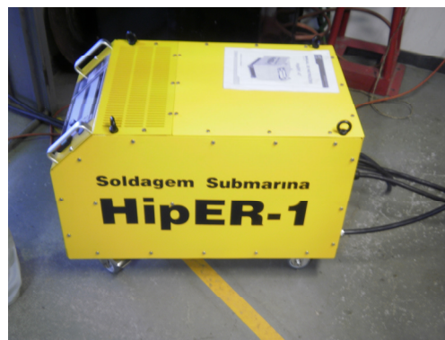
Figura 2.2. Fuente de poder (cortesía Universidad Federal de Minas Gerais).
