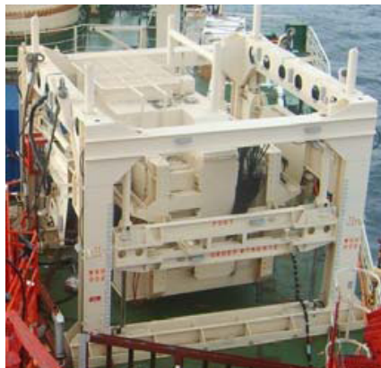
Figura 2.1. Habitat para soldadura submarina seca [2].
