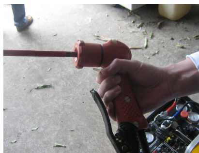
Figura 2.6. Porta electrodo para soldadura submarina (cortesía Instituto Tecnológico Boca del Río).
