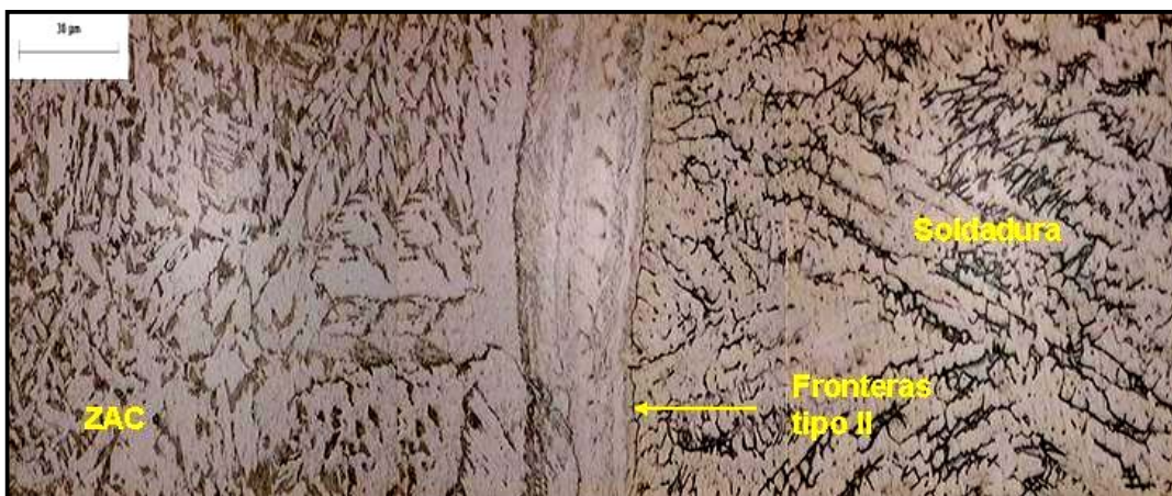
Figura 6.17. Microestructura de la muestra 3. Crecimiento de los granos austeníticos de la soldadura a partir de fronteras de granos tipo II.
