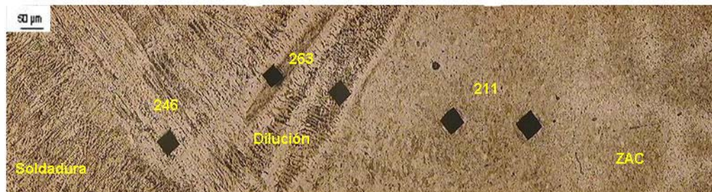
Figura 6.20. Perfil de microdureza Hv en las muestras tratadas térmicamente.
