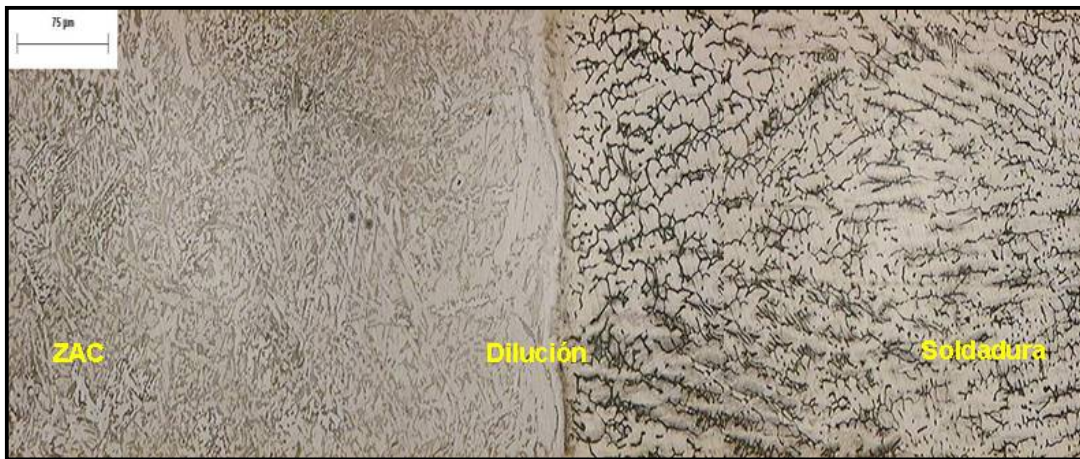
Figura 6.15. Microestructura de la muestra 2. a) Mapeo de la soldadura, interfase o zona de dilución y zona afectada por el calor.
