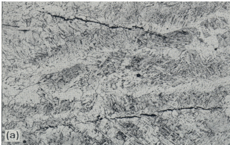
figura 6.3. Origen y apariencia típica de una grieta en una soldadura [4]
