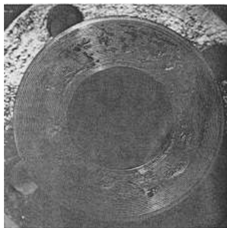
Figura 7. Corrosión por esquicios de una junta de acero inoxidable.
