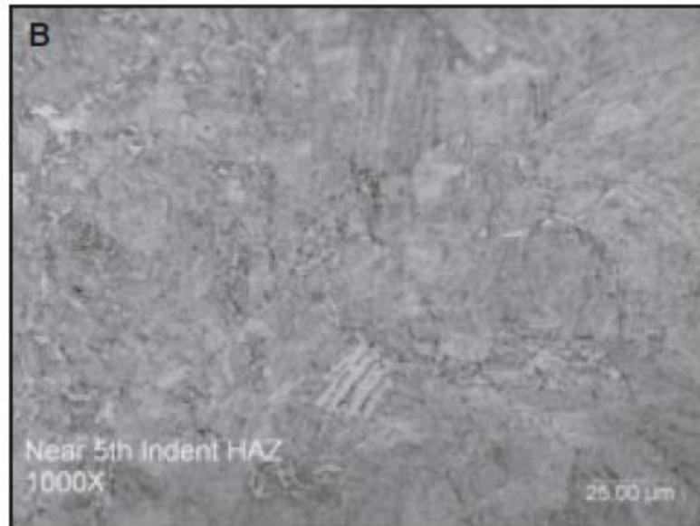
Figura 2.39 Muestra la microestructura de la HAZ del acero DP 780, con alto porcentaje de enfriamiento, martensita con áreas de bainita [38] .
