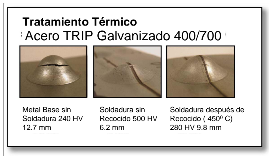
Figura 2.16 Muestra la Cantidad de alargamiento para Acero TRIP Galvanizado 400/700. [6].
