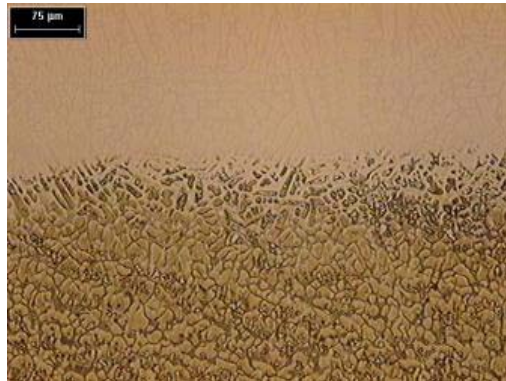
Fotografía 4.9. Carburos primarios M_{23}C_6 en matriz de Martensita revenida.
