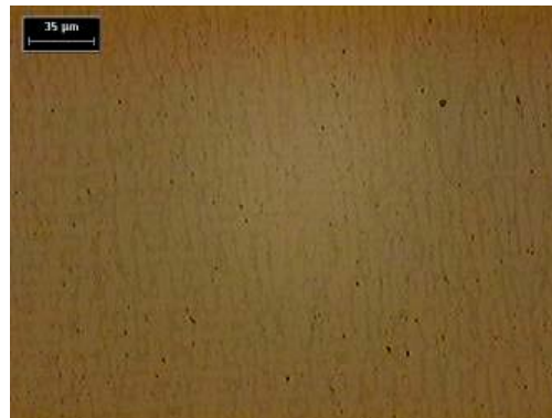
Fotografía 4.13. Granos columnares de solidificación. 200X. Picral
