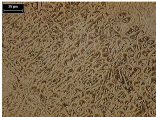
Fotografía 4.7. Granos columnares de solidificación, con precipitación interdendrítica de carburos primarios. 200X. Picral
