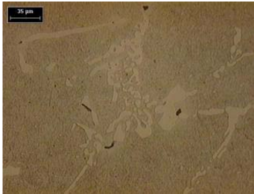
Fotografía 4.11. Carburos primarios M_{23}C_6 en matriz de Martensita revenida. 200X. Picral
