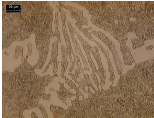
Fotografía 4.14. Carburos primarios M_{23}C_6 en matriz de Martensita revenida. 500X. Picral
