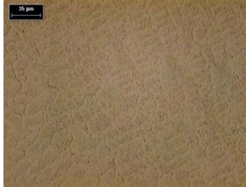
Fotografía 4.16. Granos columnares de solidificación. 200X. Picral
