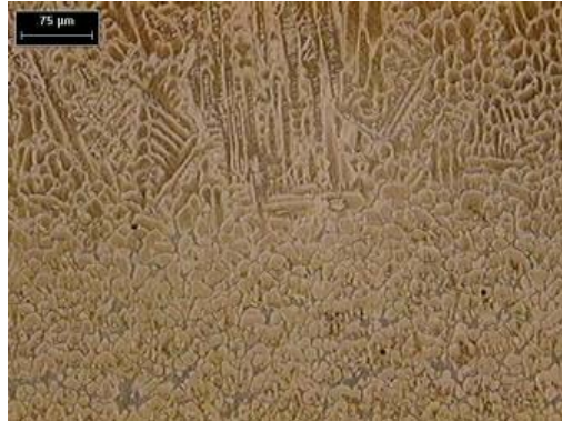
Fotografía 4.6. Carburos primarios M_{23}C_6 en matriz de Martensita revenida. 100X. Picral
