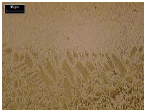
Fotografía 4.15. Carburos primarios M_{23}C_6 en matriz de Martensita revenida. 200X. Picral
