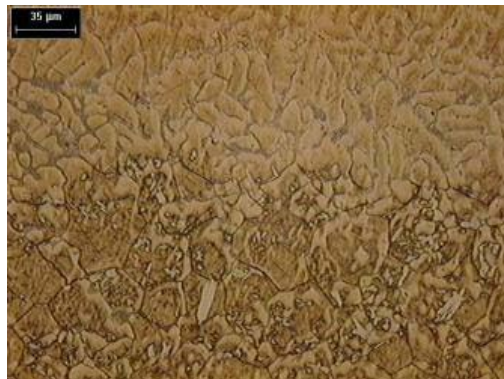
Fotografía 4.3. Carburos primarios M_{23}C_6 en matriz de Martensita revenida. 200X. Picral
