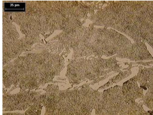
Fotografía 4.2. Carburos primarios M_{23}C_6 en matriz de Martensita revenida. 200X. Picral
