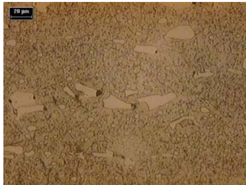
Fotografía 4.8. Carburos primarios M_{23}C_6 en matriz de Martensita revenida.
