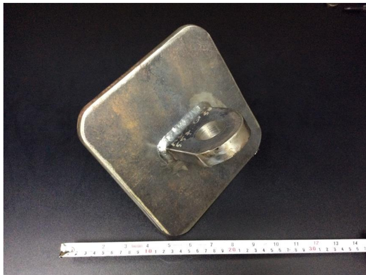
Figura 4. 21 Probeta para ensayo de tensión.
