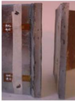
INCLUSIONES DE ESCORIA EN PLACAS DE ACERO SOLDADAS
