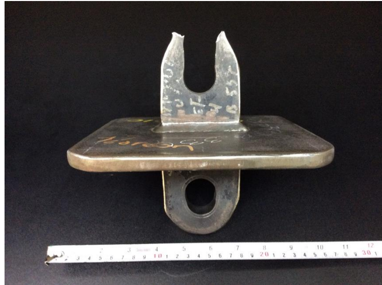
Figura 4. 24 Fractura en el metal base del lado externo de la oreja.
