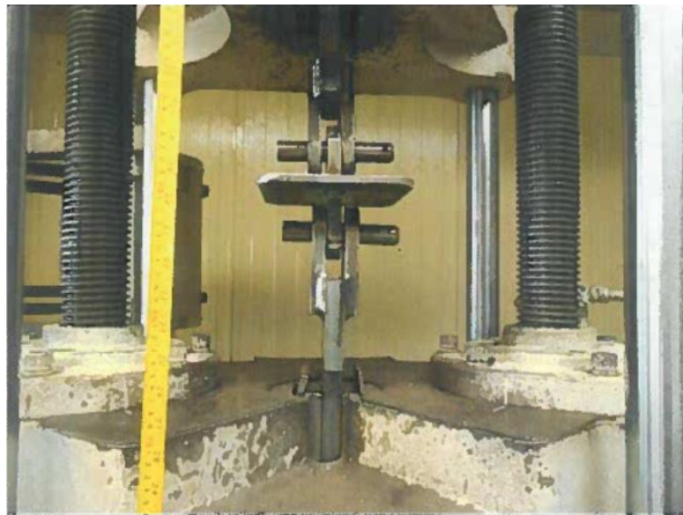
Figura 4. 23 Colocación esquemática del componente para aplicar la carga.
