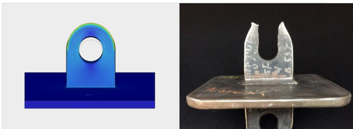
Figura 5. 1 Comparación de la localización de esfuerzos mediante el software de simulación y el ensayo real de tensión.
