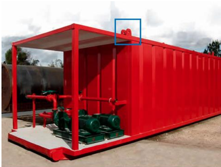
Figura 4. 2 Tanque de almacenamiento (Se observa en recuadro orejas de izaje).
