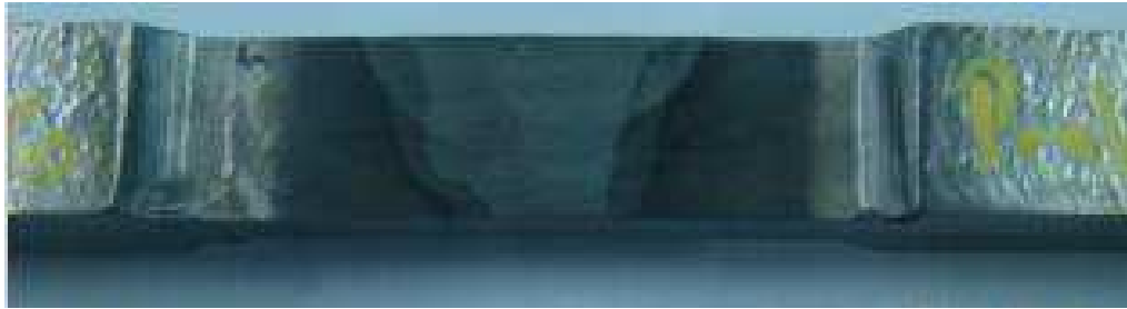
Figura 5. 16 Fotografía de la probeta maquinada de la soldadura con cara de raíz de 0 mm
