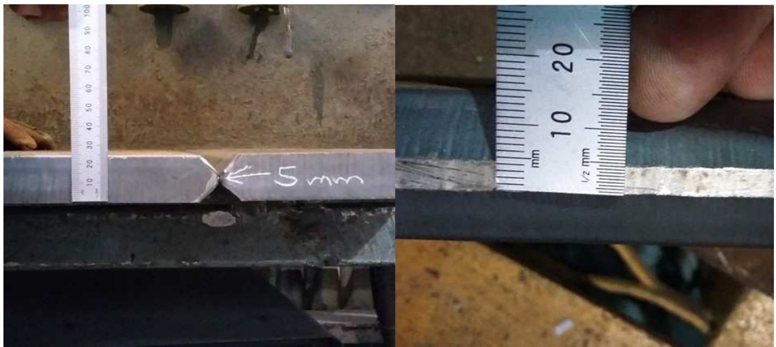
Figura 4. 4 Configuración de la unión de cara de raíz de 5 mm resultante del proceso de corte a plasma (Cortesía de la compañía fabricante de cajas para camión)
