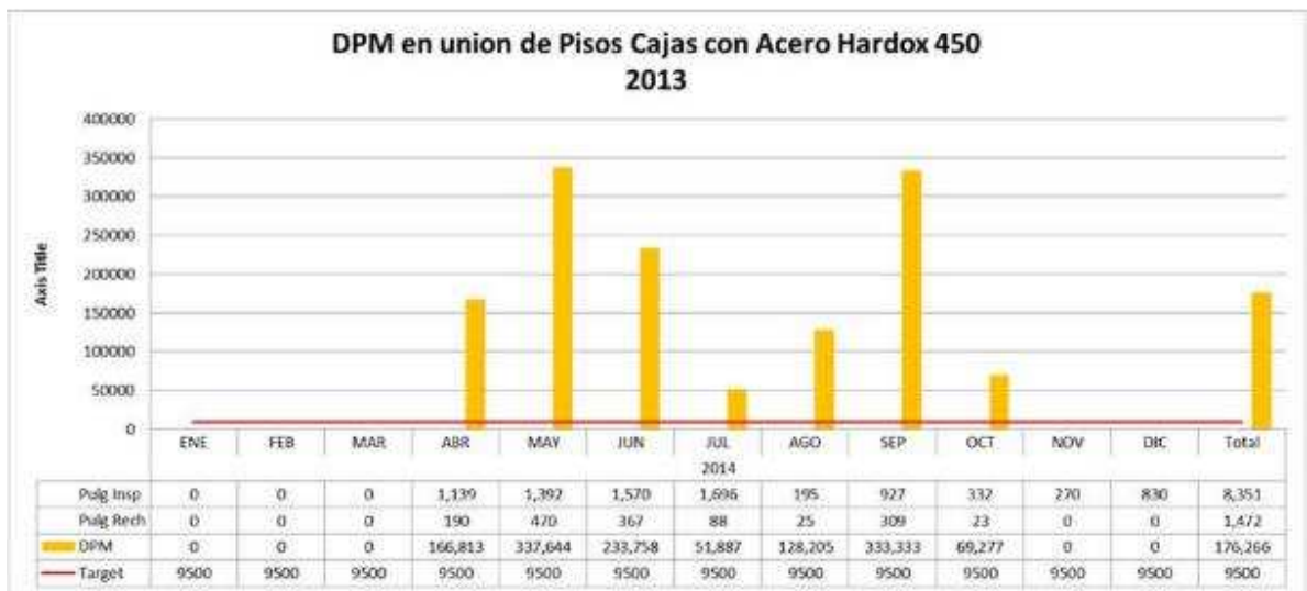
Figura 1. 1 Gráfica de defectos por millón de falta de fusión detectados por Ultrasonido de la Caja Oil Sand 2013 (Cortesía de la compañía fabricante de cajas para camión)
