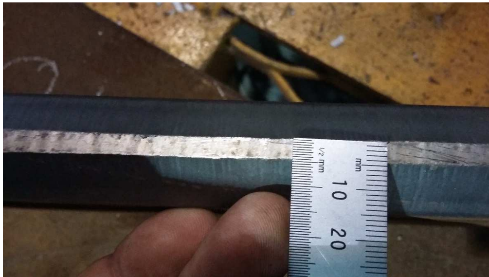
Figura 4. 2 Cara de raíz de 5 mm detectada en el muestreo de las placas resultantes en las camas de corte a plasma (cortesía de la compañía fabricante de cajas para camión minero)
