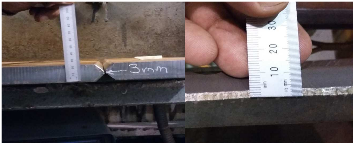
Figura 4. 5 Configuración de la unión de cara de raíz de 3 mm resultante del proceso de corte a plasma y desbaste adicional con pulidor (Cortesía de la compañía fabricante de cajas para camión)
