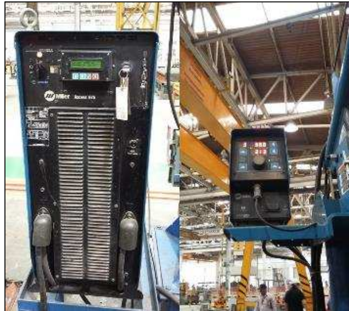
Figura 4. 7 Máquina de soldar Miller Axxess 675 (Cortesía de la compañía fabricante de cajas para camión)
