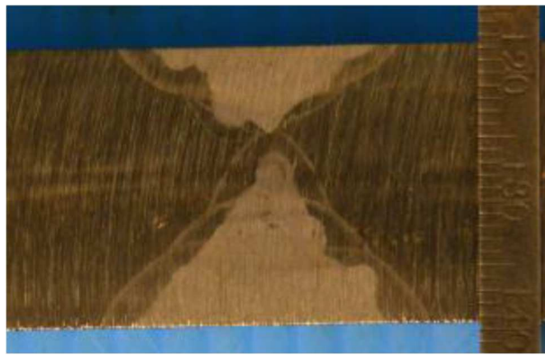
Figura 5. 2 Macrografía de la unión con cara de raíz de 5 mm con falta de fusión en la raíz
