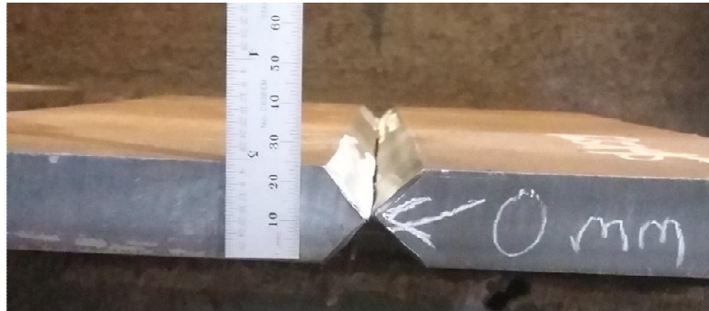
Figura 5. 12 Configuración de la unión de cara de raíz de 0 mm resultante del proceso de corte a plasma y desbaste adicional con pulidor
