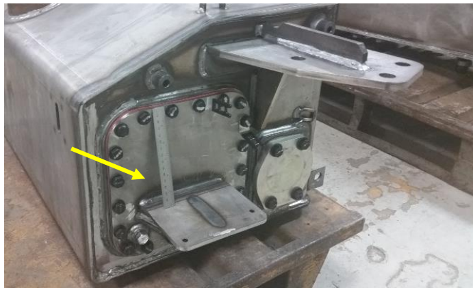
Figura 4.2 Subensamble con distorsión en uno de sus vértices (30)
