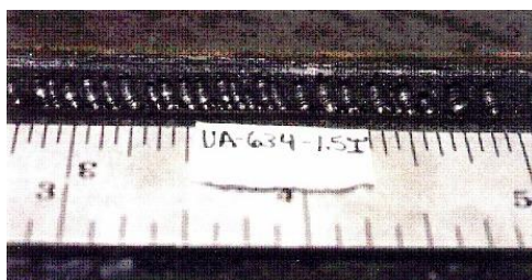
Figura 2.48 Porosidad en túnel sub-superficial a lo largo del metal soldado (28)
