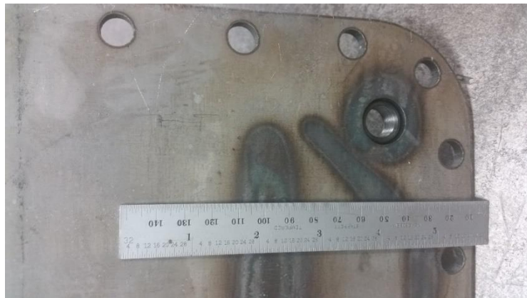
Figura 4.4 Cara anterior del vértice con distorsión (30)
