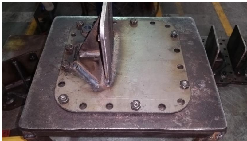
Figura 4.6 Fijación rígida del subensamble para la secuencia de soldadura (30)
