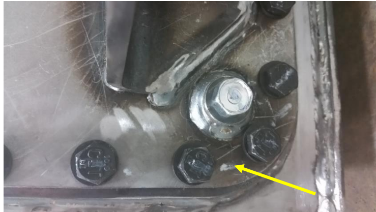
Figura 4.3 Cara frontal del vértice que presenta distorsión (30)
