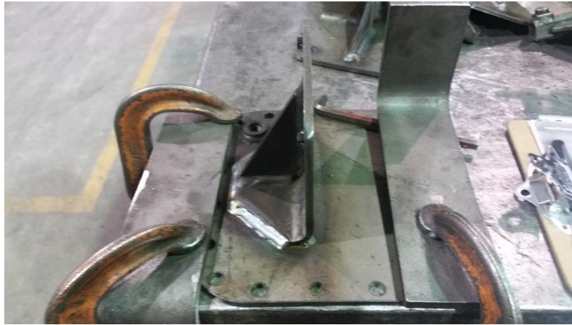
Figura 4.5 Control de la distorsión por fijación rígida y disipación de calor (30)
