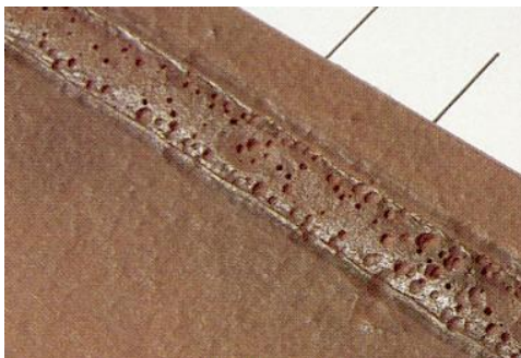
Figura 2.44 Porosidad distribuida uniformemente a lo largo del cordón de soldadura (28)
