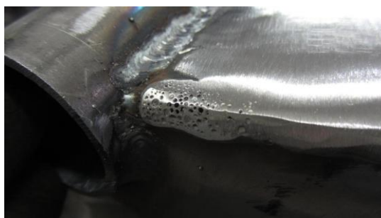
Figura 2.46 Porosidad agrupada al final del cordón de soldadura (28)
