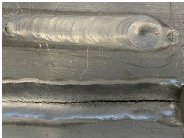
Figura 2.32 Fractura longitudinal en el centro de la soldadura (28)
