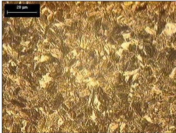
**Figura 2.10** Esquema de la microestructura de los aceros Martensíticos.
