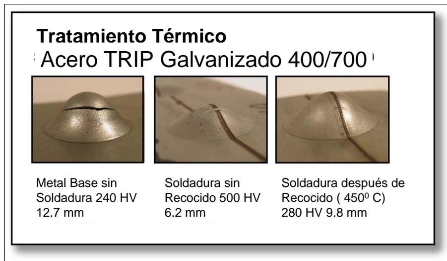
**Figura 3.7** Muestra la Cantidad de alargamiento para Acero TRIP Galvanizado 400/700.
