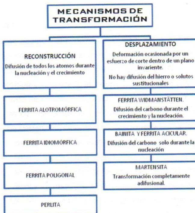
**Figuras 5.1** Diagrama de Flujo de los mecanismos de transformación en estado sólido presentes en un metal soldado. .
