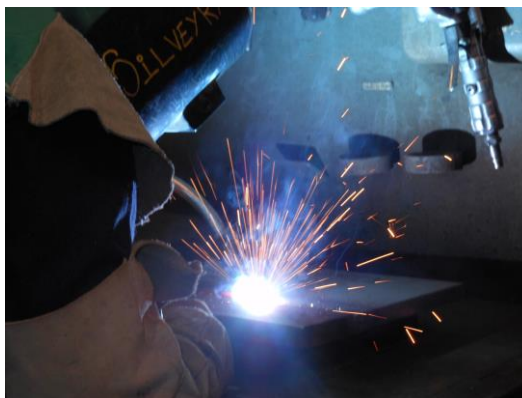
Figura 4. 1 Proceso de soldadura GMAW [cortesía CATERPILLAR]
