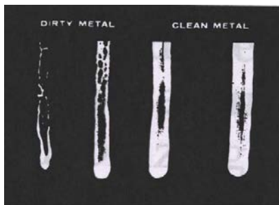
Figura No. 8.4 Inspecciones de limpieza con luz negra.
