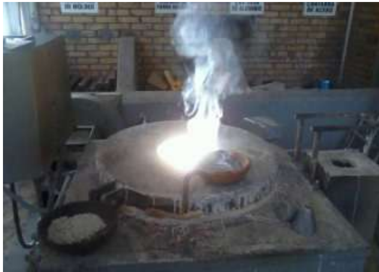
Figura C.3. Reacción del magnesio en el fundido
