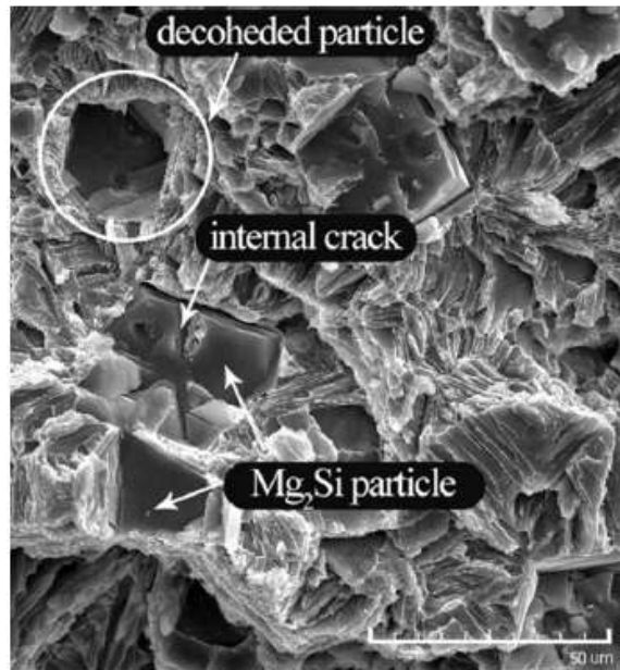
Figura 2.34. Micrografía de fractura típica en una superficie de fractura en material compuesto Al-15%Mg 2 Si sin contenido de Cr. (30)
