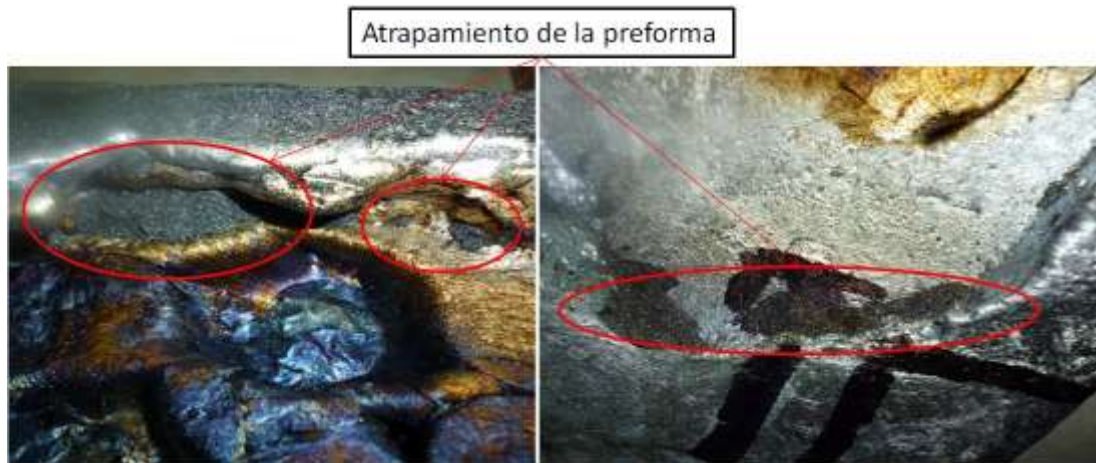
Figura C.6. Posibles áreas de infiltración de preforma de SiC en aleación Al-Si-Mg.
