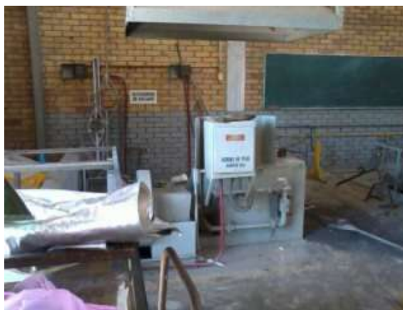
Figura C.2. Horno de piso e instalaciones empleadas para la fusión de aleación base de aluminio.
