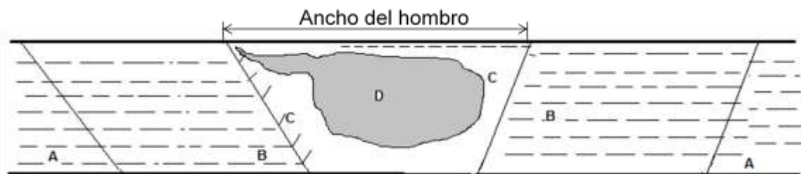
Figura 2.8. Microestructuras típicas en aleaciones base aluminio mostrando A. Metal base (BM), B. Zona afectada por el calor (HAZ), C. Zona termomecánicamente afectada (TMAZ), D. Nugget de soldadura (WN). Área de avance se encuentra a la izquierda. (5)
