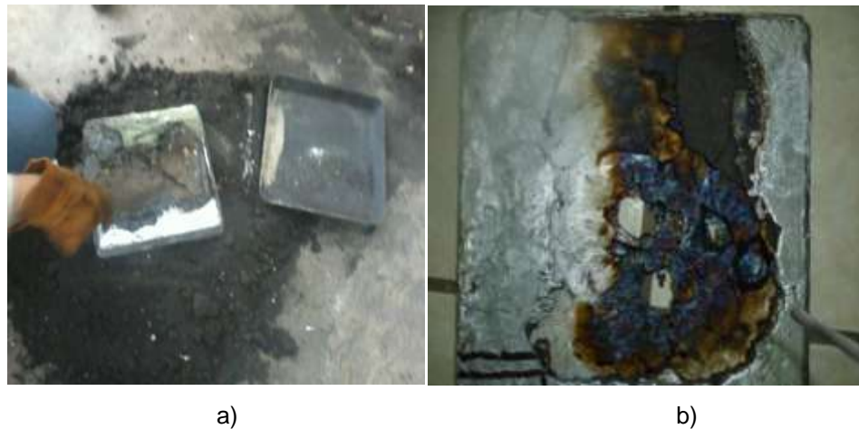
Figura C.5. a) Pieza recién desmoldada sobre cama de arena, b) Pieza metálica resultante después de limpieza y enfriamiento
