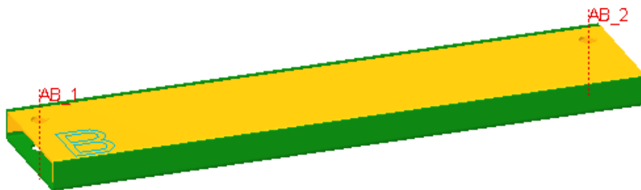
Figura 3.7.- Cara superior de parte B. Ejes AB_1 y Ejes AB_2 de la pieza de trabajo. Vista en isométrico.
