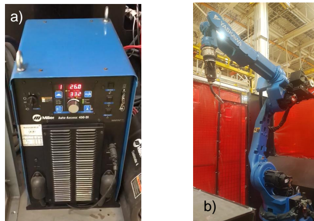
Figura 3.17.- Equipo usado para la experimentación, a) máquina de soldar, b) robot industrial de soldadura.
