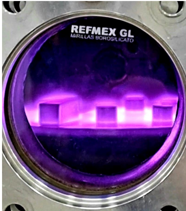
Fig. 3.9 Probetas durante proceso de nitruración iónica.
