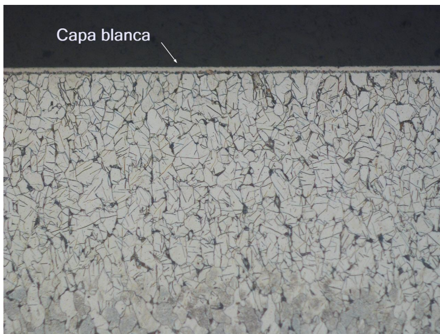
Fig. 5.6 Micrografía 200X de una muestra nitrurada (Nital 5%).
