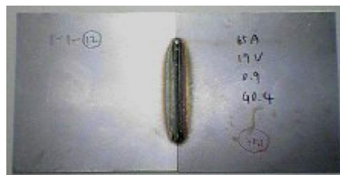
Figura 3.4 Soldadura parcial placa de acero dulce [66].
