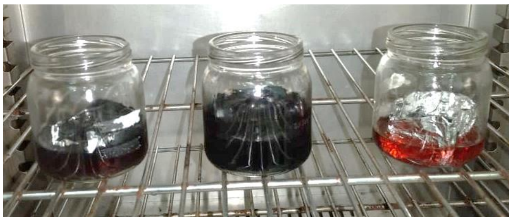
Figura 4.6. Cupones con la aleación mecánica y solución colocados para su deshidratación.
