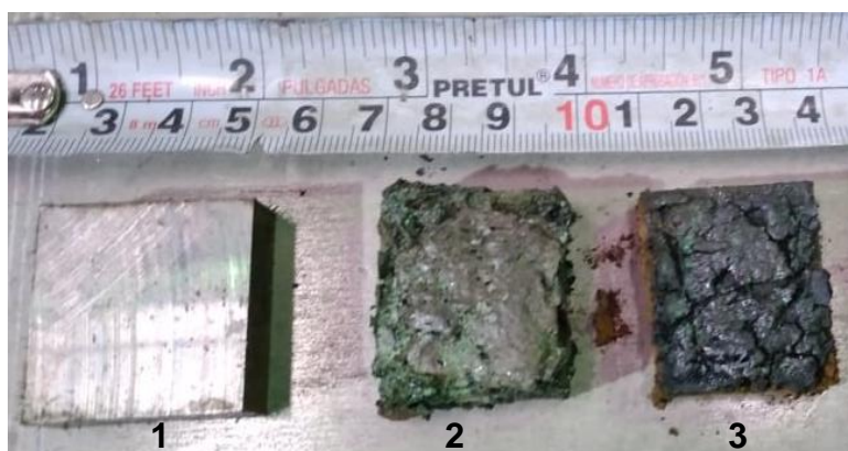
Figura 4.7. Muestras obtenidas mediante el proceso Sol-Gel.
