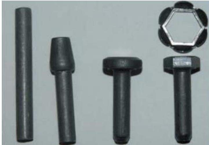
Figura 2.8 Progresión del conformado del tornillo M5X12, hasta su forma final [23].
