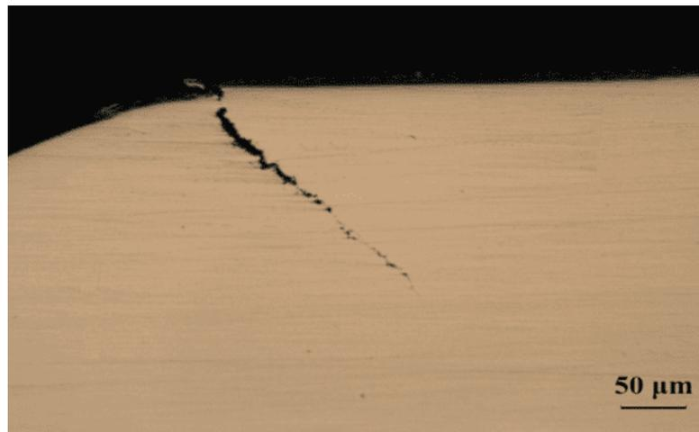
Figura 3.29 Micrografía que muestra una grieta superficial [46].
