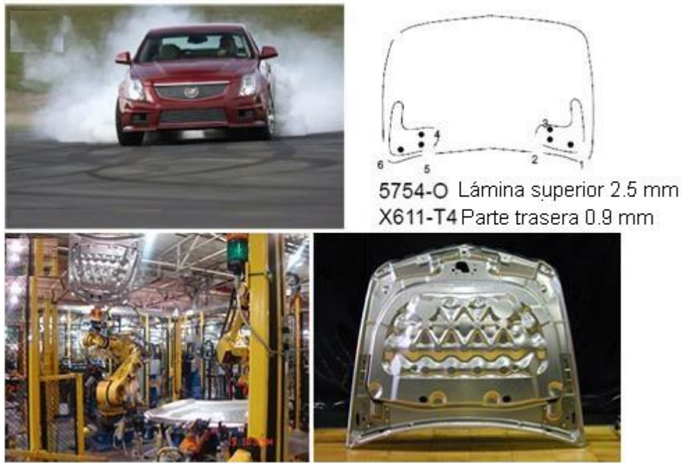
Figura 3.19 Algunos ejemplos ilustrativos de la soldadura FSSW aplicados en la industria automotriz (las fotografías cortesía del Dr. Blair Carlson, General Motor), Mishra et al. (2014).
