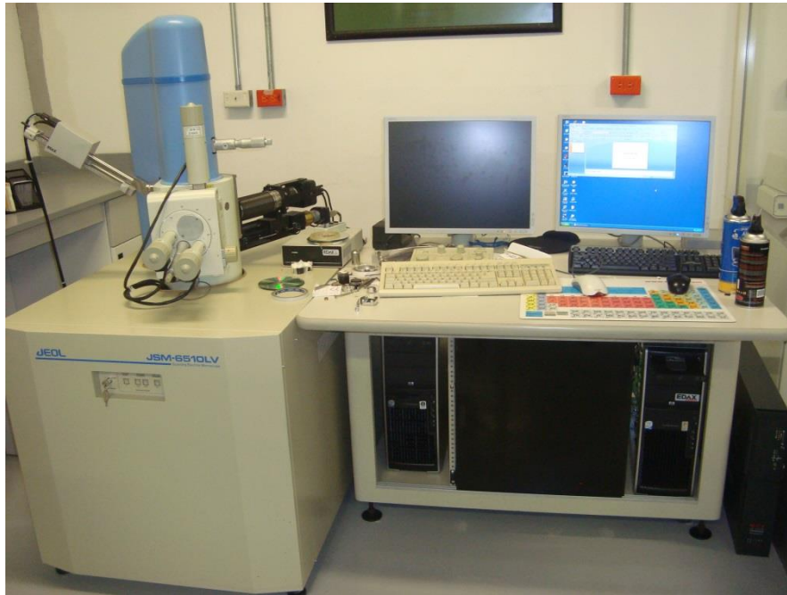
Figura 4.10 Microscopio electrónico de barrido Oxford Jeol JSM-6490-LV-15kV
