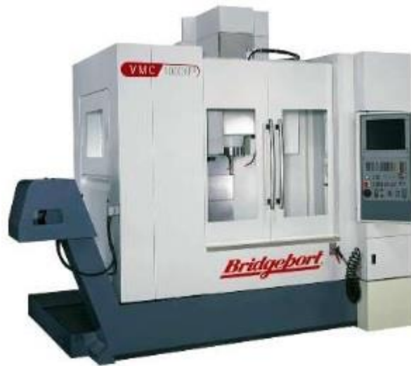
Figura 4.4 Centro de maquinado CNC marca Bridgeport modelo VMC 760 XP 3 en la cual se realizaron las soldaduras.
