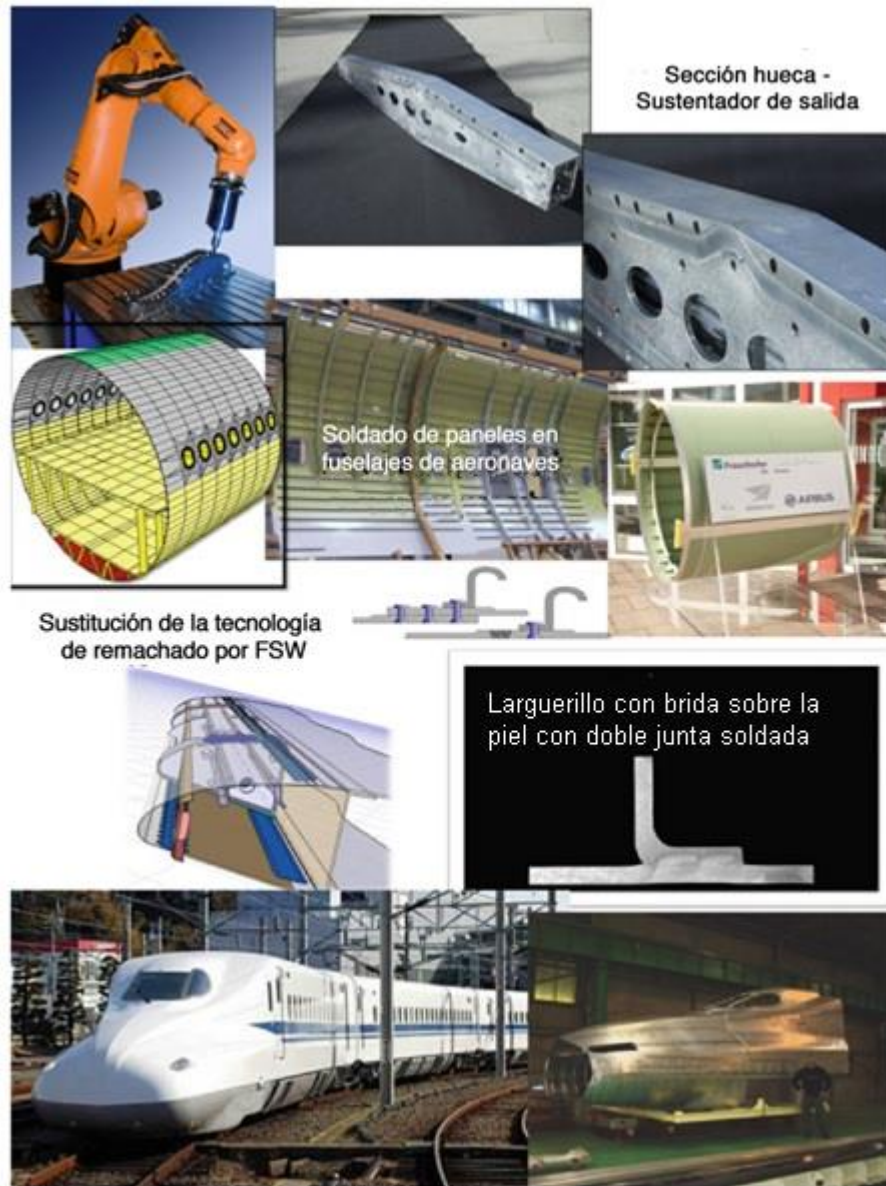
Figura 3.18 Algunos ejemplos ilustrativos de la aplicación de la soldadura FSW (todas las fotografías relacionadas con las aeronaves son cortesía de Grupo Airbus, Ottobrunn, Germany and Shinkansen cortesía del Sr. Gilbert Sylva), Mishra et al. (2014).
