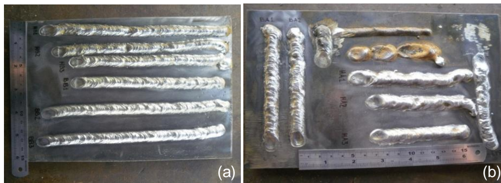
Figura 4. Cordones de soldadura aplicados con ángulo de trabajo de 50° (a) y 70° (b).
