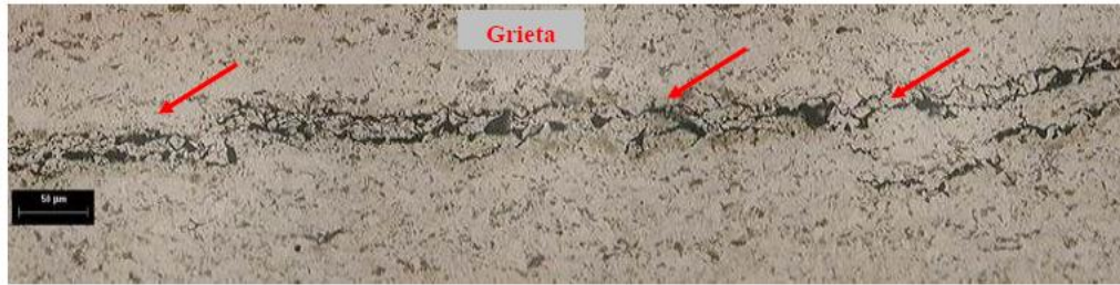
Figura 5. Agrietamiento por hidrógeno con aspecto escalonado, 100X.
