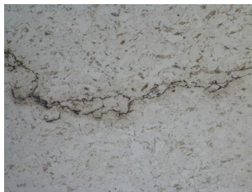
Figura 6. Comportamiento del agrietamiento por hidrógeno, 200X.
