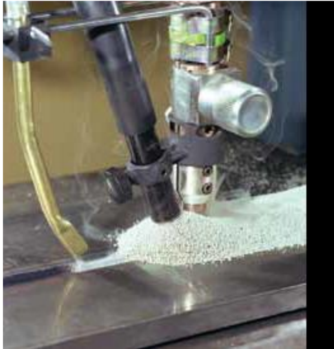
Figura 2.1 Proceso de soldadura por arco sumergido (14).
