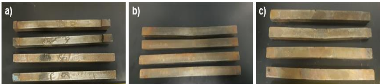
Figura 6.4 Muestras al final de la prueba de SSC. a) prueba de 3 días, b) prueba de 7 días y c) prueba de 20 días.
