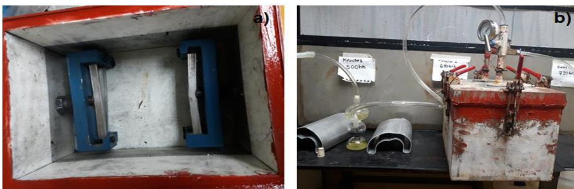
Figura 5.12 Prueba de corrosión a) acomodo de las piezas dentro del reactor. b) prueba en ejecución.
