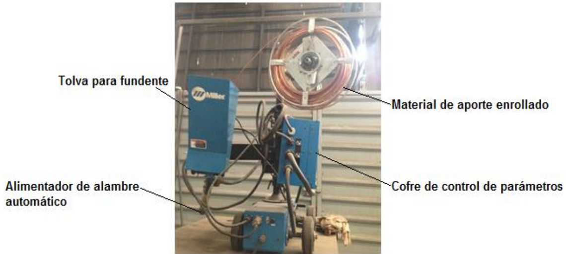
Figura 5.4 Equipo semiautomático de soldadura por arco sumergido (SAW).
