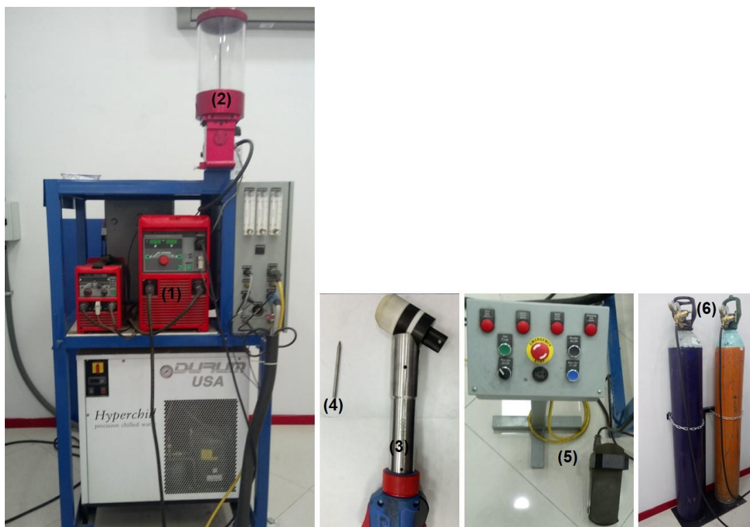
Figura 3.5. Fotografía de los componentes básicos del equipo para el proceso de soldadura PTA.
