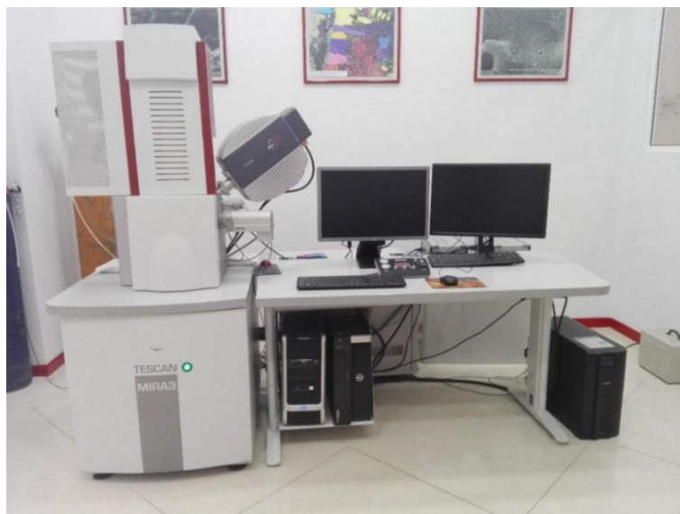
Figura 3.4. Fotografía del microscopio electrónico de barrido.
