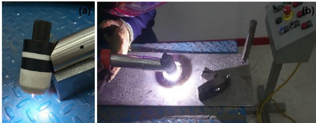
Figura 3.6. Fotografías de (a) arco piloto o arco inicial y (b) la aplicación del recubrimiento por soldadura PTA.
