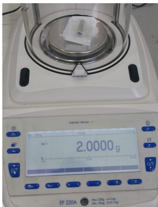
Figura 3.2. Fotografía de la balanza utilizada para pesar las partículas.
