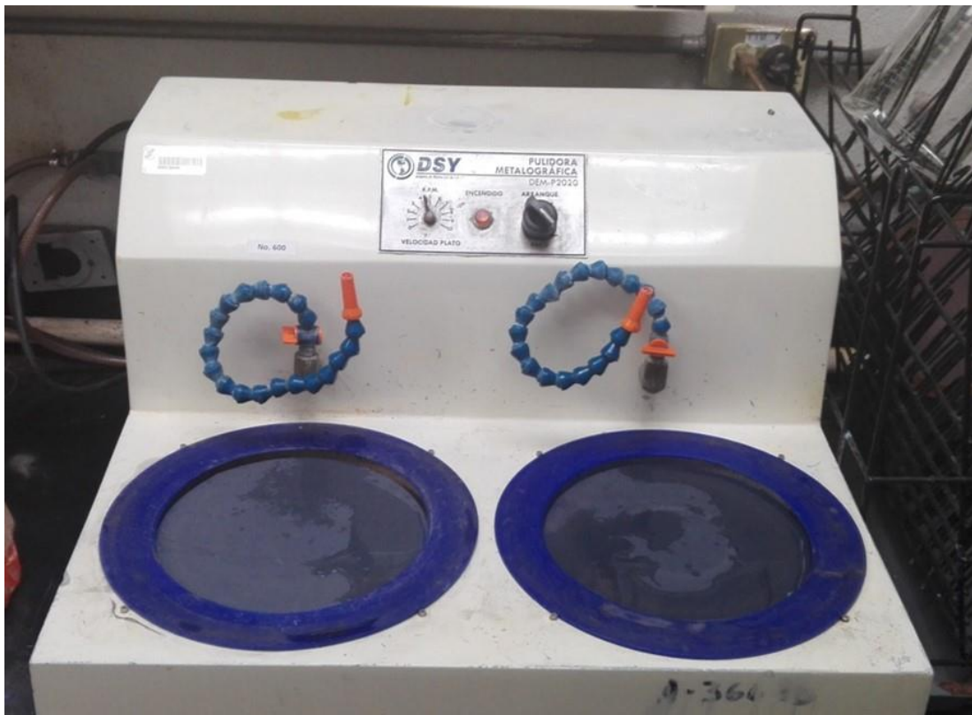
Figura 3.8. Fotografía de pulidora metalográfica de dos discos.
