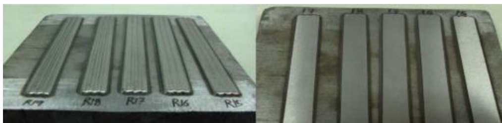
Figura 2.4: Placa con deposición de capas de acero inoxidable martensítico por medio de proceso LBW [7].
