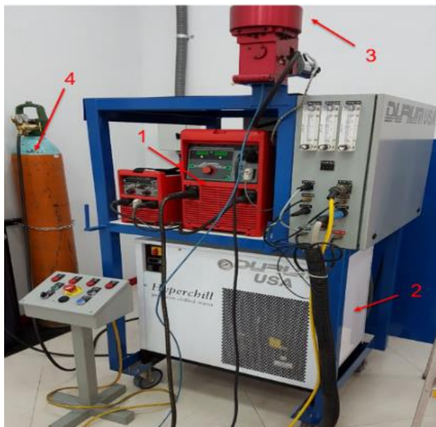
Figura 2.7: Equipo PTA; 1.- Generador de corriente. 2.- Sistema de enfriamiento. 3.-Contenedor de polvo. 4.- Cilindro de gas de protección.
