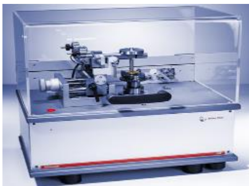
Figura 2.10: Equipo de tribología Pin-on-disk [21].
