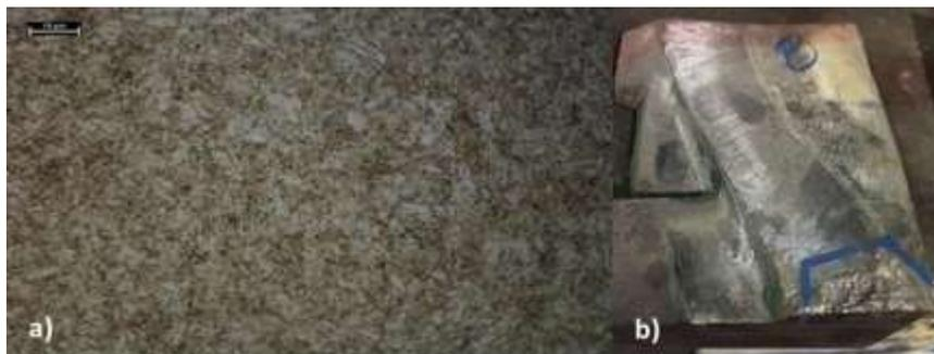
**Figura 1. a) Microestructura de material base, b) Inserto de acero H13 dañado**
