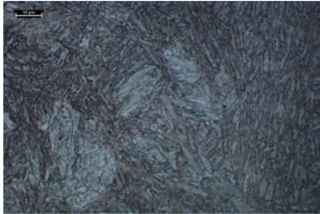
**Figura 2. Microestructura de zona de fusión (acero H13)**
