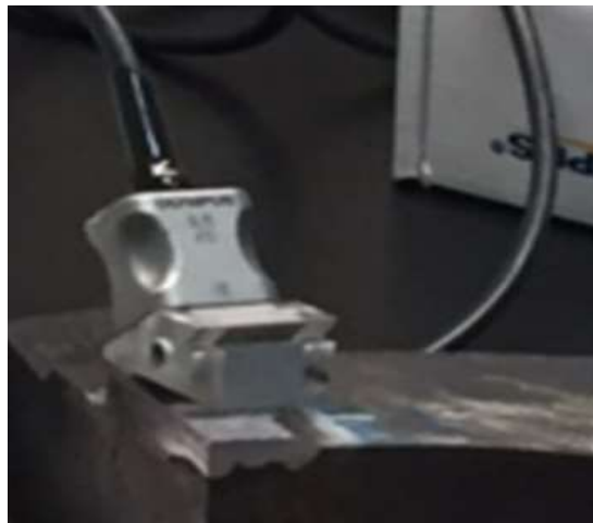
Figura 4. 4 Inspección de inserto soldado con ultrasonido
