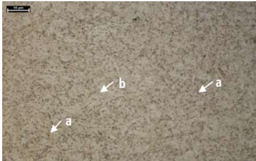
Figura 4. 1 Imagen de microestructura de acero H13 vista a 100x con presencia de carburos (a) y martensita (b)
