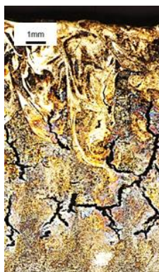
Figura 2.9. Agrietamiento en recubrimiento producido vía micro-joining.
