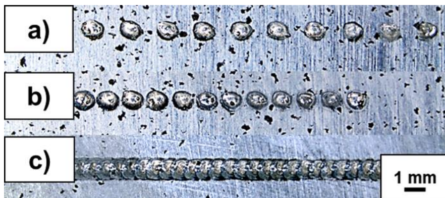
Figura 4.15 Cordones producidos en pruebas preliminares.
