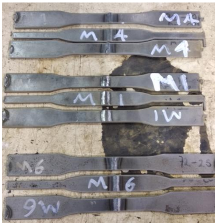
Figura 3.6 Corte de las probetas 1, 4 y 6, según la norma para realizar el ensayo de tensión.
