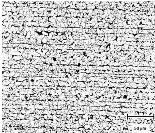
Figura 2.2 Microestructura de un acero HSLA, con perlita alargada en forma de bandas y granos ferríticos [16].
