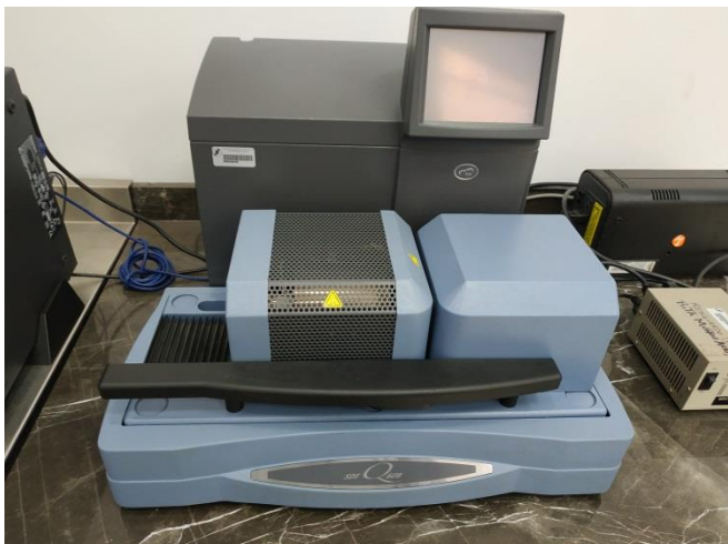
Figura 4.4 Equipo DSC-Tg para realizar la soldadura brazing de las muestras de aluminio sin y con películas de Bi
