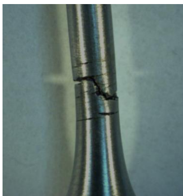
Fig. 8. Probeta después de la ruptura en una prueba de SSC, mostrando las grietas que se forman debido al efecto combinado del esfuerzo y el ambiente amargo.
