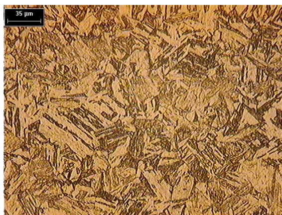
Fig. 2. Microestructura del acero 17-4 PH posterior al tratamiento térmico de solubilizado y envejecido.
